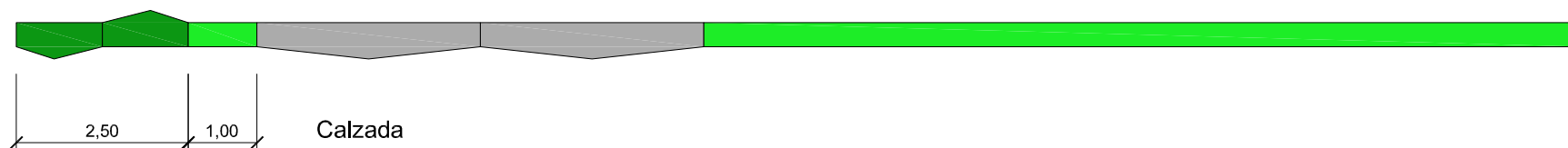
Sección tipo en tramos de nueva ejecución
